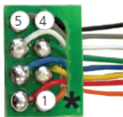
Afbeelding 8 : LokPilot 5 Fx micro met 8 polige NEM652 stekker aansluiting
